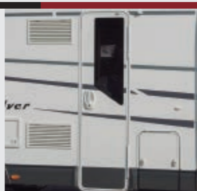
Porte cellule avec baie, store et moustiquaire.
