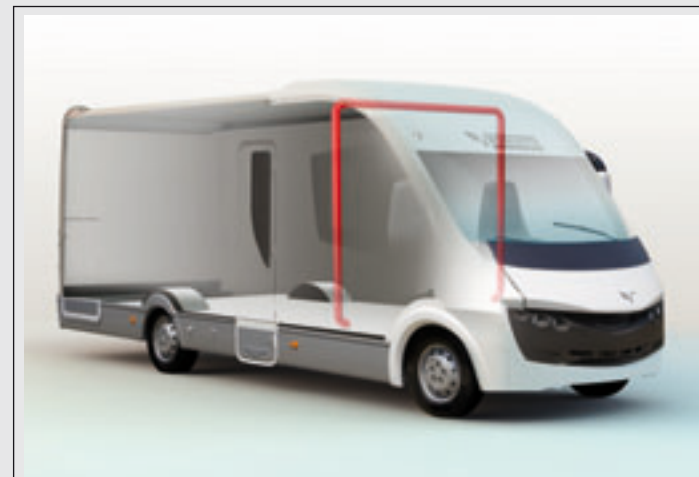
Pour une meilleure sécurité de ses occupants, la structure avant est équipée d'un Rollbar résistant (arceau de protection).
