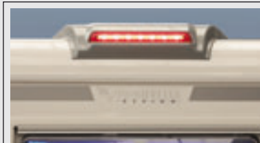
Troisième Feu de freinage encastré dans le profil arrière thermoformé.
