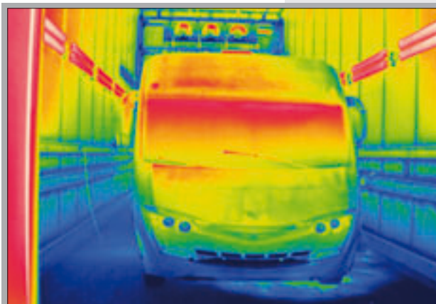
Test de chauffage conforme à la norme EN 1646-1 avec Truma Combi 6.
