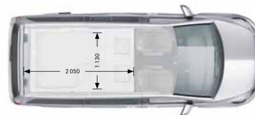
Cotes exprimées en mm. Les valeurs moyennes indiquées s'entendent pour le véhicule à vide avec dotation de série. Lorsque le toit est relevé, la hauteur intérieure peut atteindre jusqu'à 2,35 m.
