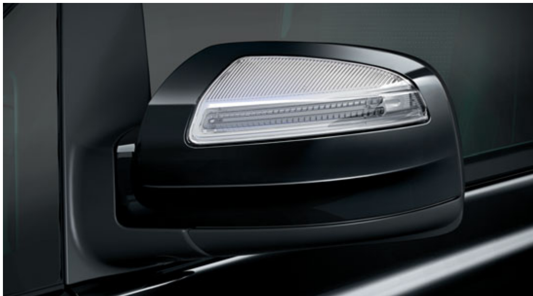
Retrovisori esterni con campo visivo allargato e indicatori di direzione integrati, regolabili elettricamente.
