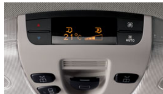
Scambiatore di calore supplementare per il vano posteriore con gruppo comandi separato.
