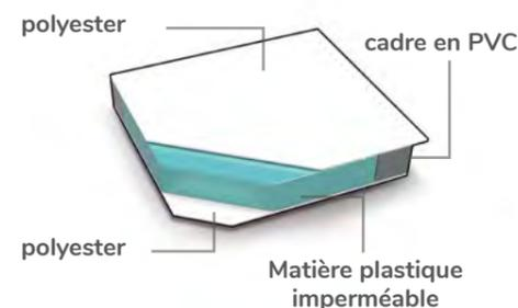
**PLANCHER** de 54 mm d'épaisseur, avec revêtement interne en PVC antidérapant et résistant à l'abrasion, composé d'une plaque externe en fibre de verre et interne multicouche en PVC et d'inserts en matière plastique imperméable.
