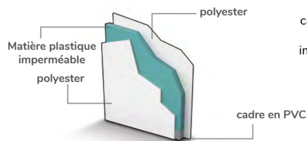
**PAROIS** avec double feuille de fibre de verre, externe et interne, cadre en PVC et inserts en matière plastique imperméable, épaisseur 30 mm.
