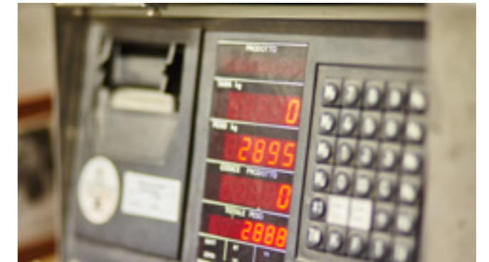
Pesage électronique de 100 % des véhicules avant la livraison et certification écrite du poids au client final.
