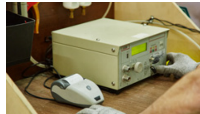
Test des systèmes de gaz par du personnel certifié selon le protocole allemand DVGW.
