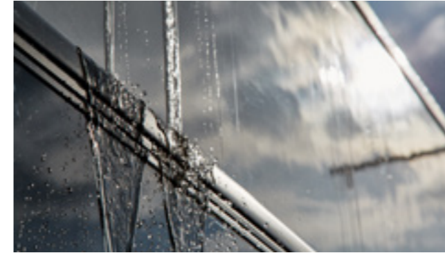
Test d'étanchéité contre l'infiltration d'eau à 100 % des camping-cars sortant de production, avant livraison.
