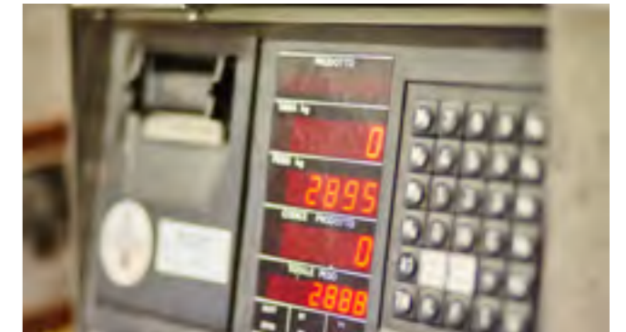
Pesage électronique de 100 % des véhicules avant la livraison et certification écrite du poids au client final.
