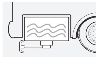
**RÉSERVOIR EAUX** usées avec une résistance Anti gel (OPT)
