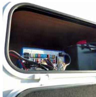
Le réseau électrique est placé dans un coffre technique accessible depuis l'extérieur.
