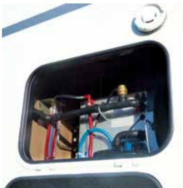
Un coffre technique facilite l'accès à la centrale du chauffage ALDE®.
