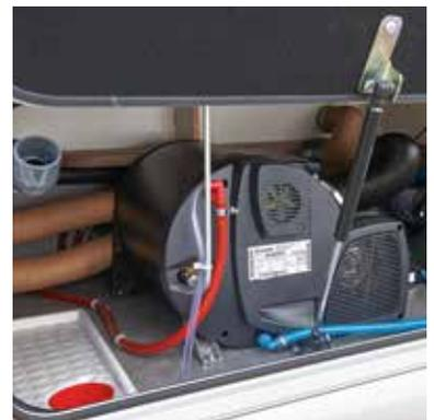
Chauffage et eaux pour entretien, remplissage et vidange des réservoirs : tout est centralisé dans un coffre technique.
