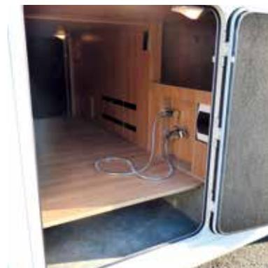
Une soute décaissée avec plancher amovible en 3 parties.
