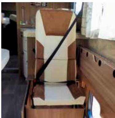
Le siège route, pliable sous la banquette, est également amovible pour libérer l'espace et la charge utile.
