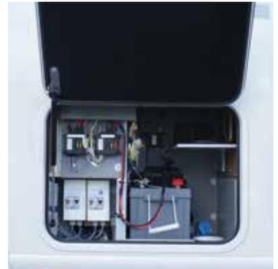
Le bloc technique électrique logé sous la partie réfrigérateur est accessible de l'extérieur.
