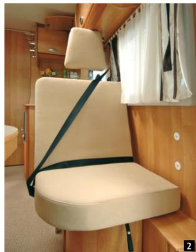
**1** Soute isolée. **2** Un système exclusif homologué de banquette face route et ceintures 3 points alliant confort à l'étape et sécurité sur la route.
