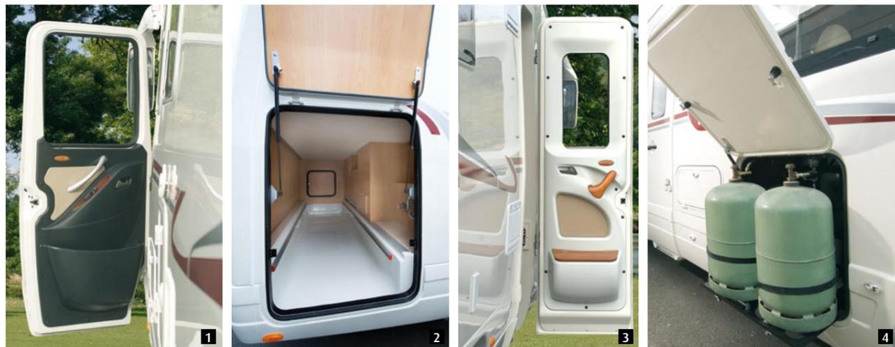
**1** Porte chauffeur en polyester, de type automobile, avec une nouvelle garniture intérieure, à fermeture centralisée (serrures Mercedes).
