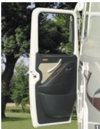
1 Porte chauffeur en polyester, de type automobile, avec une nouvelle garniture intérieure, à fermeture centralisée (serrures Mercedes). 2 Nouvel arrière. 3 Porte cellule.
