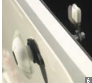
4 Tiroirs polyester en bas de caisse. 5 Coffre à gaz isolé et coulissant. 6 Nouvelles portes de coffre avec serrure à compression.
