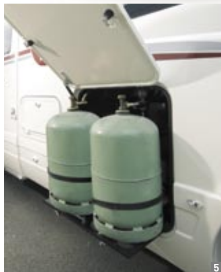
4 Tiroirs polyester en bas de caisse. 5 Coffre à gaz isolé et coulissant. 6 Nouvelles portes de coffre avec serrure à compression.
