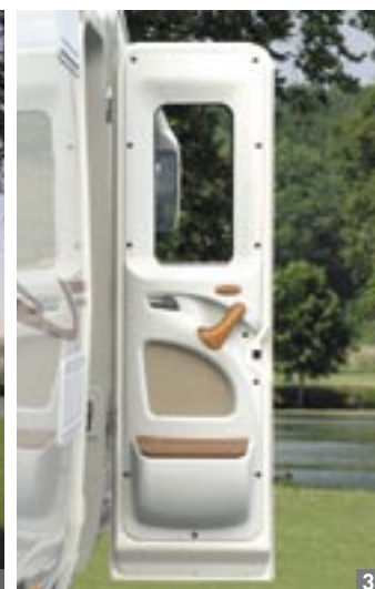
1 Porte chauffeur en polyester, de type automobile, avec une nouvelle garniture intérieure, à fermeture centralisée (serrures Mercedes). 2 Nouvel arrière. 3 Porte cellule.
