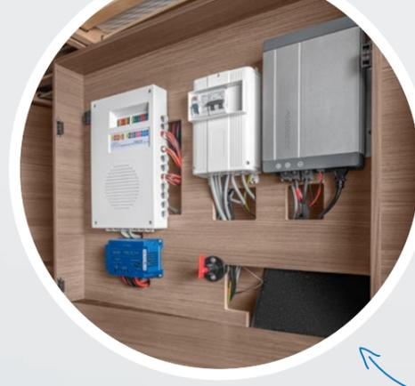
*Parfaitement organisé ! Grâce au positionnement central de l'ensemble du système électrique du véhicule, comme ici avec le VAN TI dans le garage arrière, tous les éléments importants sont facilement accessibles et clairement disposés. Cela permet de gagner du temps en cas de maintenance*
