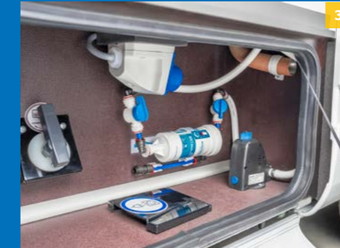
3. Le filtre peut être conservé jusqu'à 6 mois à partir du jour de l'installation. Un bouton spécial affiche l'état actuel.
