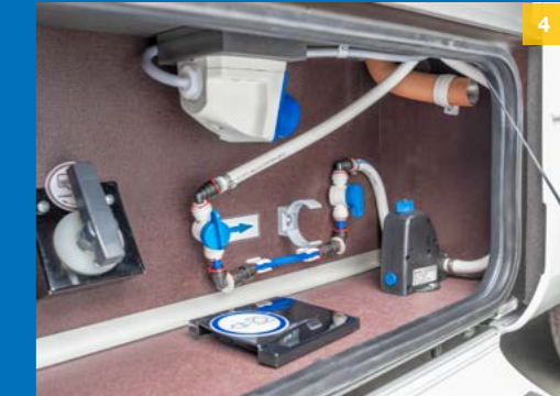
4. Si aucun filtre de rechange n'est disponible, la pièce intermédiaire garantit l'alimentation en eau.
