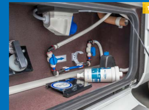
1. Afin que vous puissiez utiliser le filtre à eau jusqu'à 6 mois, il n'est monté que lorsque le véhicule est livré.
