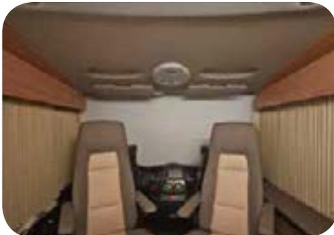
**8. Un store plissé** (se fermant de droite à gauche, de série) permet d'obscurcir et d'isoler le pare-brise et les vitres latérales. En option le store avant peut se fermer de bas en haut Autre option : le store avant électrique.
