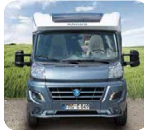
**1. La face avant :** nouvelle casquette avec baie, le pare-choc Knaus plus court de 8 cm et en option les feux diurnes à LED, ainsi que les feux antibrouillard combinés aux feux directionnels.
