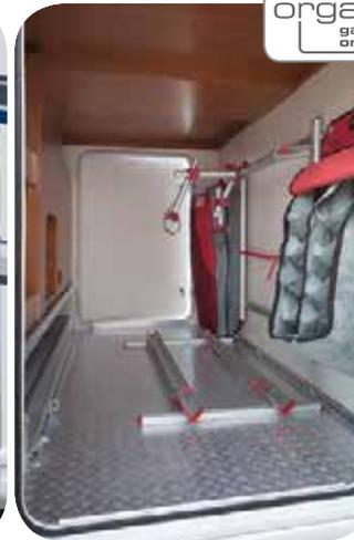
Système de rangement du garage Orga-Fix à deux rails pour sièges, pour vélos, etc. et arrimage à la cloison.
