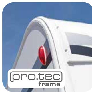
Luxeux « Pro.tec-Frame » : Profilés en aluminium tout autour du véhicule assurant une protection optimale des bords.
