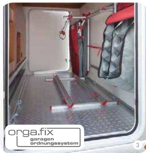
3 Deux systèmes de rangement du garage Orga-Fix au choix : avec deux rails pour sièges, vélos, etc. et arrimage à la cloison. Ou bien avec en plus un rail long à la cloison arrière, poche pour vêtements et chaussures comprise.
