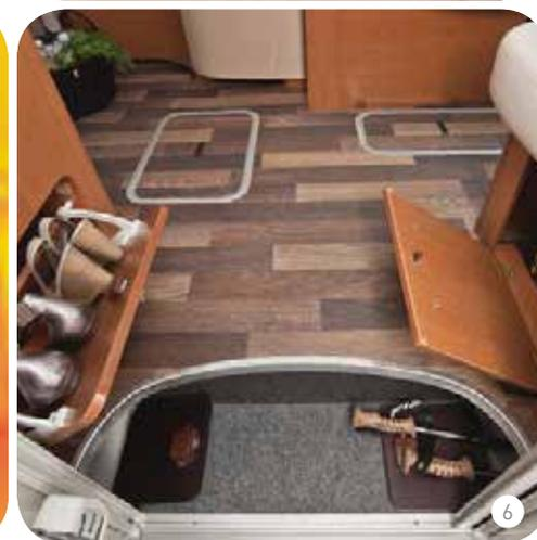
1 Service-Box Knaus innovante dans le Sky TI : facilement accessible et avec des robinets d'arrêt de l'eau / des eaux usées et intégration des batteries et de l'alimentation en eau propre.
