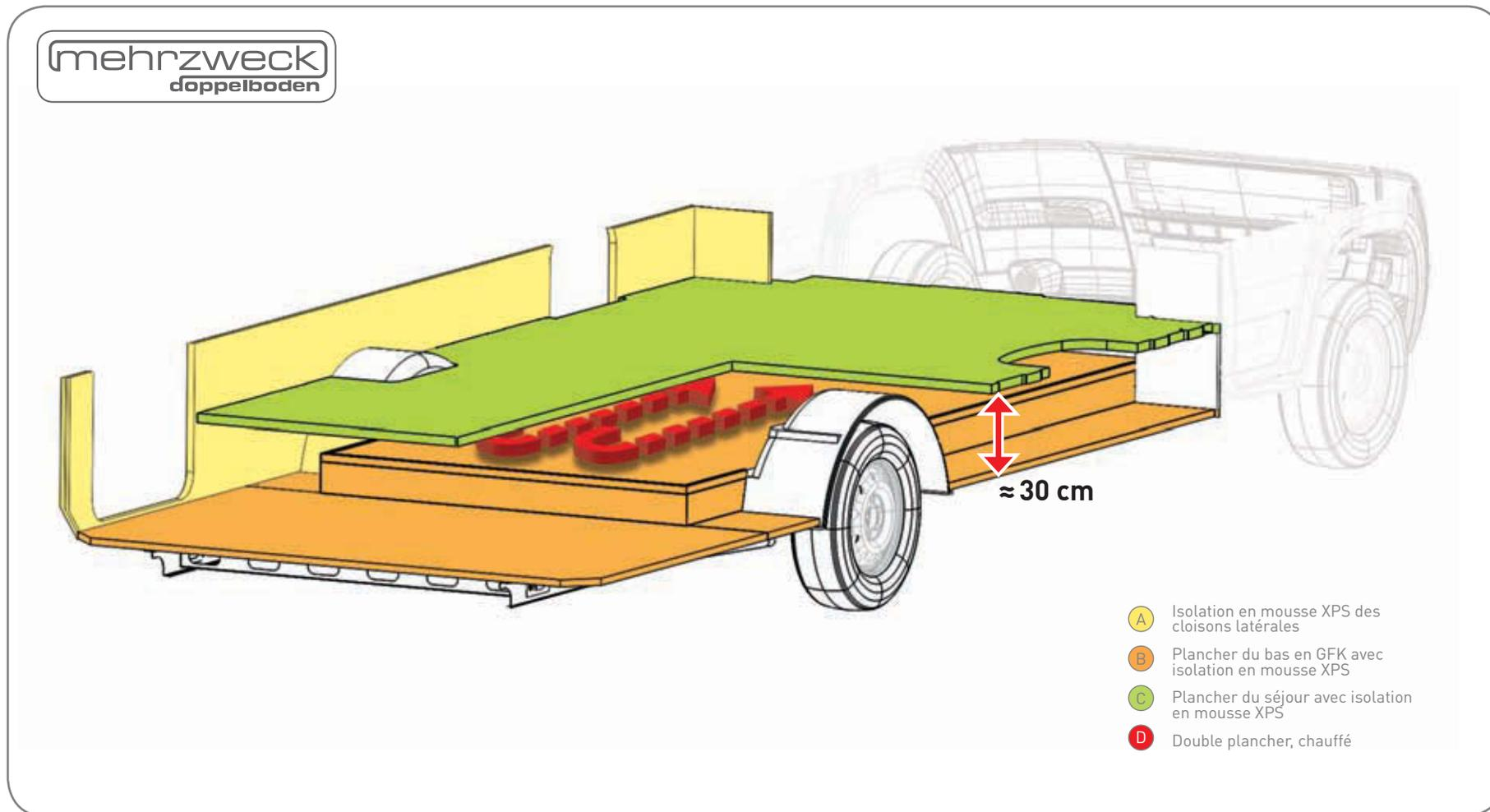
Double plancher multifonctionnel Knaus dans le Sun TI.
