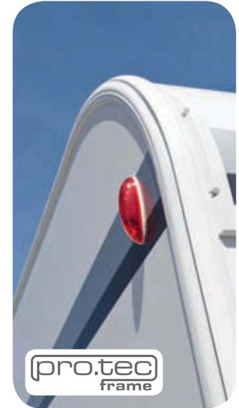
Luxeux « Pro.tec-Frame » : Profilés en aluminium tout autour du véhicule assurant une protection optimale des bords.
