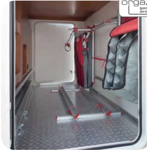
Système de rangement du garage Orga-Fix à deux rails pour sièges, pour vélos, etc. et arrimage à la cloison.
