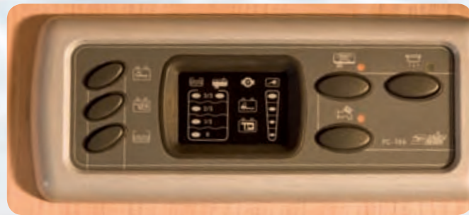
• En haut à gauche: tableau de contrôle et de commande avec commutateur principal, contrôle du niveau des réservoirs d'eau et eaux usées, de la tension de fonctionnement de 2 batteries
