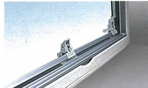
Die komfortable Einhandbedienung der „Seitz-Rahmenfenster“ verbindet alle Verriegelungen über eine Bedienstange. Ein zusätzlicher Verriegelungsschieber verhindert das Öffnen von außen.
