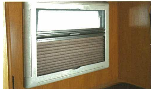
Die Fächer-Jalousie schützt durch ihre äußere Aluminium-Beschichtung vor starker Sonneneinstrahlung. Jalousie und Mückenschutz lassen sich in jeder Stellung arretieren.
