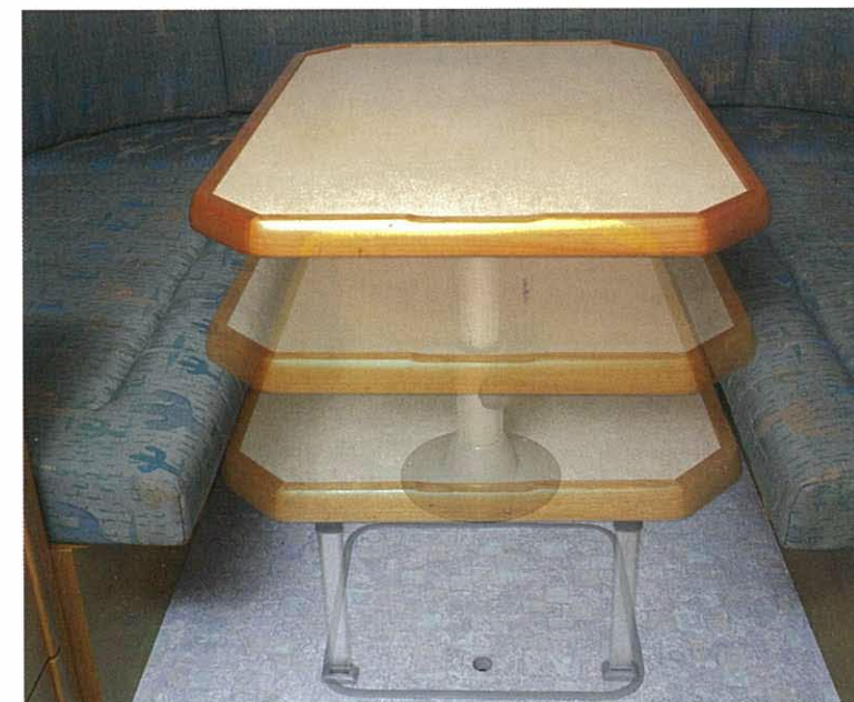
Mit einem Griff lässt sich die Tischsäule des Missouri 600 H im Boden versenken. Die Schlaffläche von ca. 200 x 142 cm bietet zwei Personen viel Platz.
