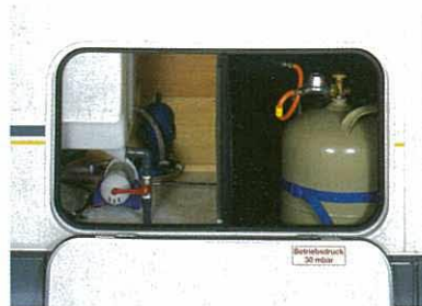
Bequem von außen zugänglich: Beim Missouri 600 H finden zwei 11-kg-Gasflaschen Platz im dafür vorgesehenen, nach innen abgedichteten Raum im Heck.
