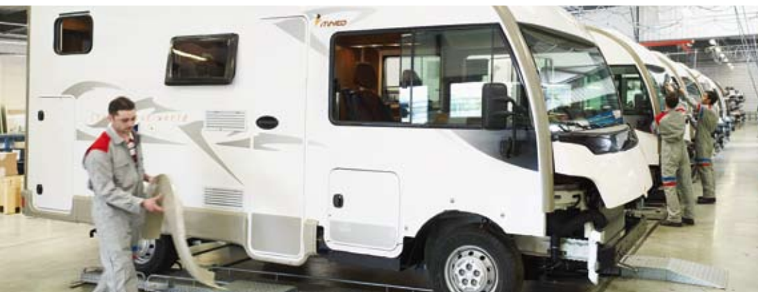
Vérification de l'étanchéité
