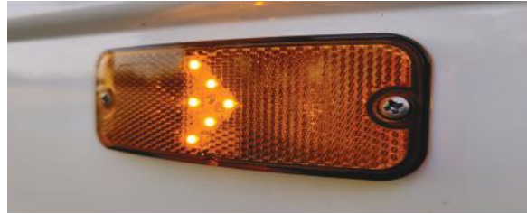
▲ Luces de gálipo laterales con indicadores de dirección lumínicos Side marker lights with lighted direction indicators Begrenzungsleuchte mit Fahrrichtungsanzeigern
