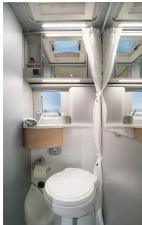
Le cabinet de toilette compact se ferme à l'aide d'une porte coulissante permettant d'économiser de la place. Lors de l'utilisation de la douche, l'armoire, le lavabo et les toilettes sont protégés des projections d'eau grâce à un rideau de douche. Un canal de drainage faisant le tour du bac à douche permet à l'eau de s'écouler sans problème.
