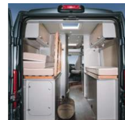
Le sommier à lattes peut être positionné à la verticale à l'arrière de l'HYMERCAR Free, créant ainsi un large passage où les objets de grande taille (par ex. les vélos) trouveront facilement leur place. Le chargement peut être sécurisé de façon optimale grâce aux œillets d'arrimage intégrés dans le plancher et le lit arrière.
