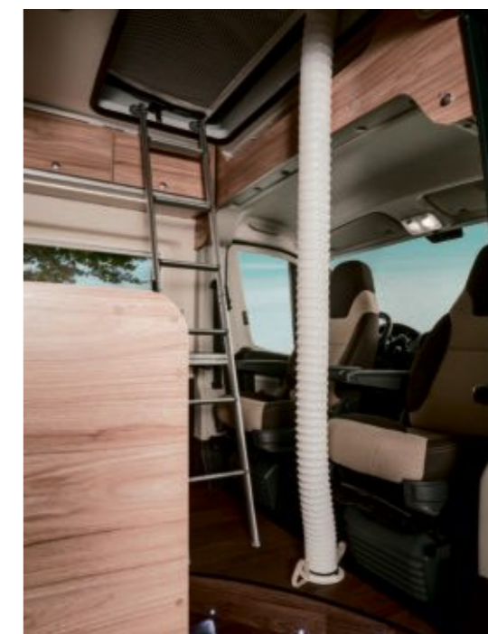
Un astucieux tuyau d'air chaud (option) servira à chauffer la zone du toit ouvrant de l'HYMERCAR.
