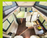
Grâce à l'insertion axiale d'un étrier de support au-dessous de la table rabattue, un lit longitudinal d'une longueur de 2,4 mètres peut être monté. Ainsi, HYMERCAR est une fois de plus le garant du confort de sommeil des personnes mesurant plus de deux mètres.
