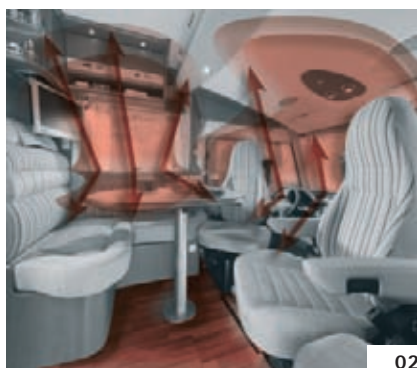
Espace d'habitation : Diffusion d'air chaud aux fenêtres et sous la dînette en L
