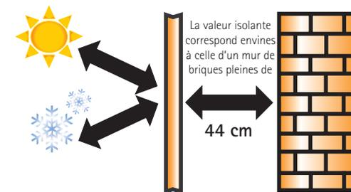
La cellule est fabriquée selon le principe réputé du système PUAL. Les panneaux possèdent ainsi des propriétés d'isolation hors du commun et les passages de roues sont également isolés séparément.
