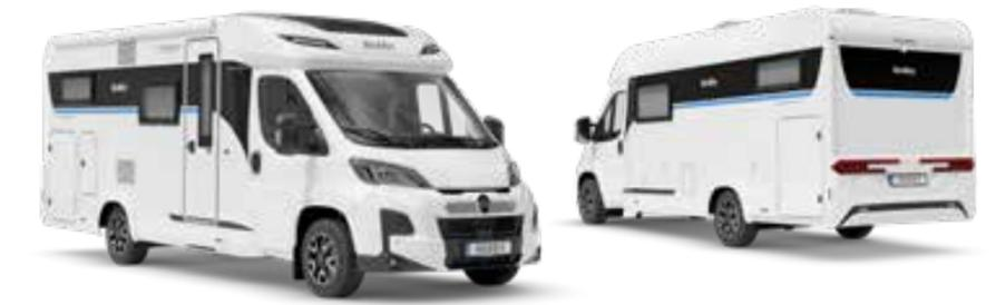
Le modèle ONTOUR C est un semi-intégré compact. Avec une largeur de 2,23 mètres, (store de toit extérieur compris) vous maîtrisez votre véhicule en toutes circonstances et négociez les virages les plus serrés, sur une route de montagne comme en plein centre-ville. Basé sur un châssis Citroën, le camping-car ONTOUR C 140 ch est disponible avec une transmission automatique sur demande. Et grâce à l'équipement complet « HobbyKomplett », le véhicule est prêt à prendre la route immédiatement.
