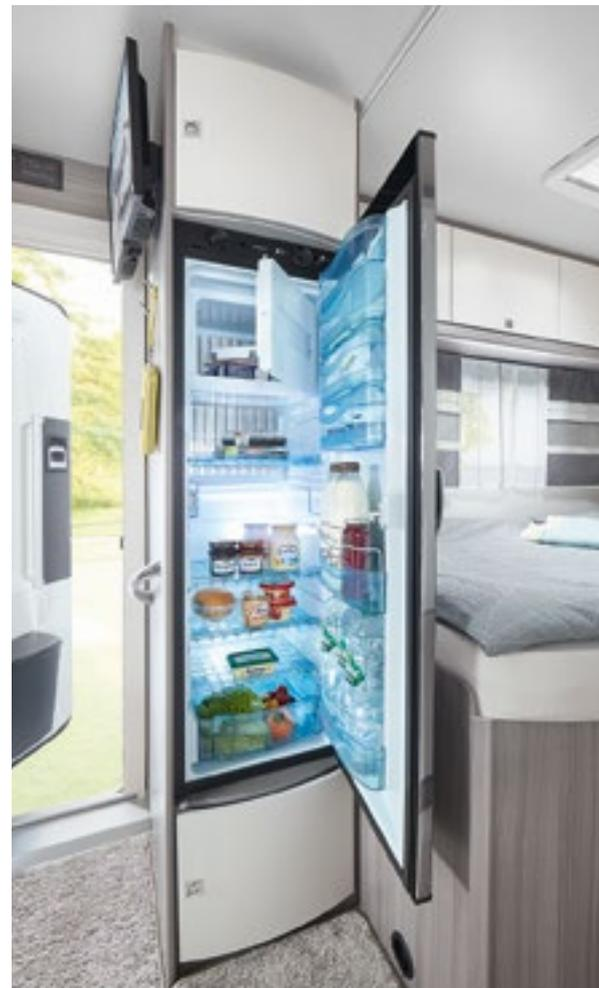
Facile d'accès, le compartiment sous le réfrigérateur permet de ranger des boîtes de conserves et des provisions. Le réfrigérateur fonctionne sur réseau électrique, et à 12 volts ou au gaz pendant le trajet.
