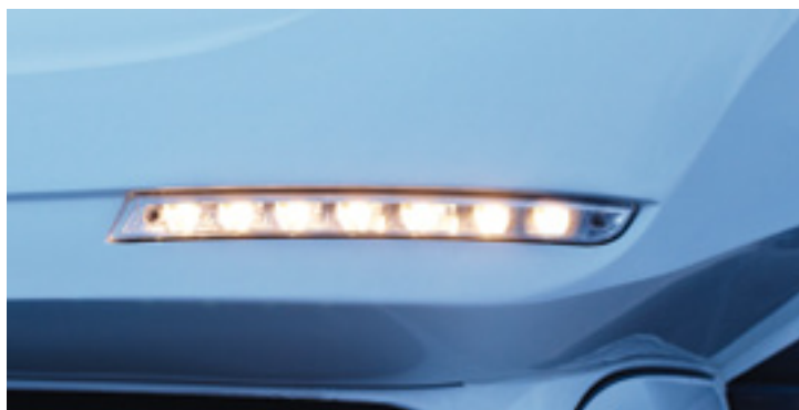
Feux de position à l'avant et à l'arrière à LED
