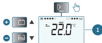
1 Menu "Réglage du seuil d'alarme température extérieure"
