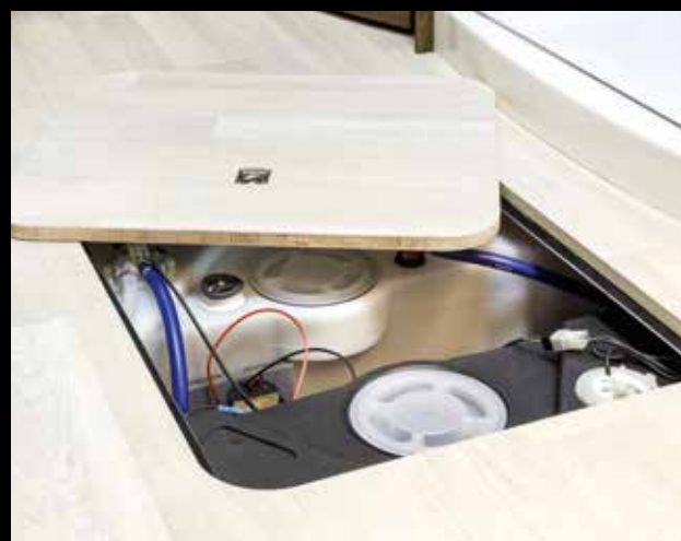
Double-plancher FRANKIA d'un seul tenant et plan sur toute la surface, accessible de l'intérieur et de l'extérieur.
