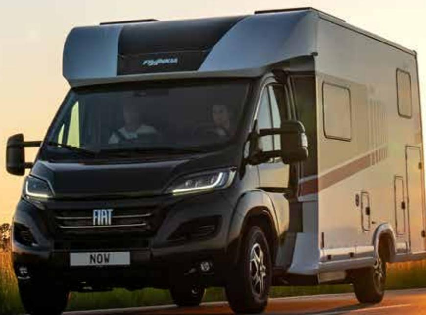
Quel que soit le style, le NOW est robuste ! C'est ce que garantit la superstructure en alliage d'aluminium et en PRV résistant à la grêle pour le toit.
