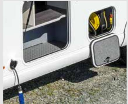
Enrouleur automatique avec câble de 15 m et compartiment de service
