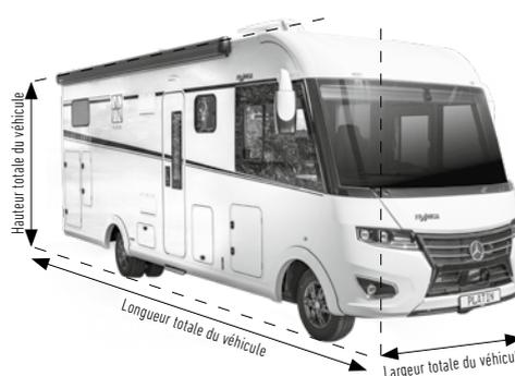
La **longueur totale du véhicule** correspond à la longueur entre le point le plus extérieur de la jupe avant et le point le plus extérieur de l'arrière (sans attelage de remorque).
