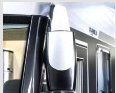
Rétroviseur extérieur électrique et chauffé
