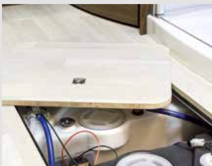
Double-plancher FRANKIA : plan sur toute la surface et entièrement chauffé
