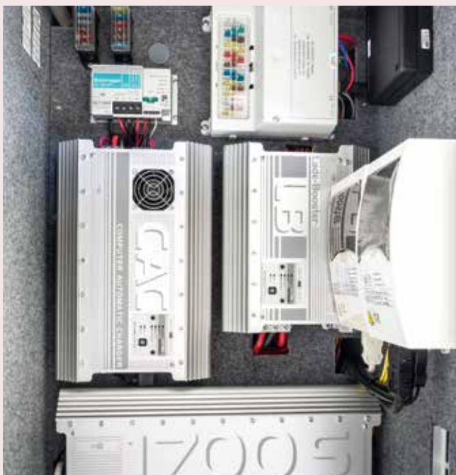
Pack technique incluant 3 panneaux solaires 110 W, onduleur sinusoïdal 1 700 W, 2 batteries Lithium 110 AH, etc.
