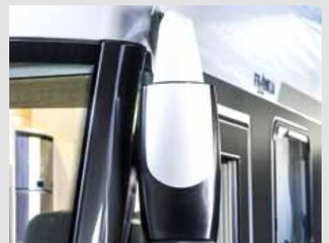
⊕ Rétroviseurs électriques et chauffés
