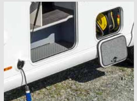
⊕ Enrouleur automatique avec câble de 15 m et compartiment de service
