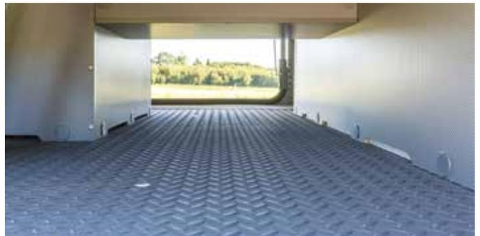
**Maximum de place** : le double-plancher de 35 cm de hauteur, entièrement chauffé, plat et traversant jusqu'à l'avant sur la plupart des modèles.
