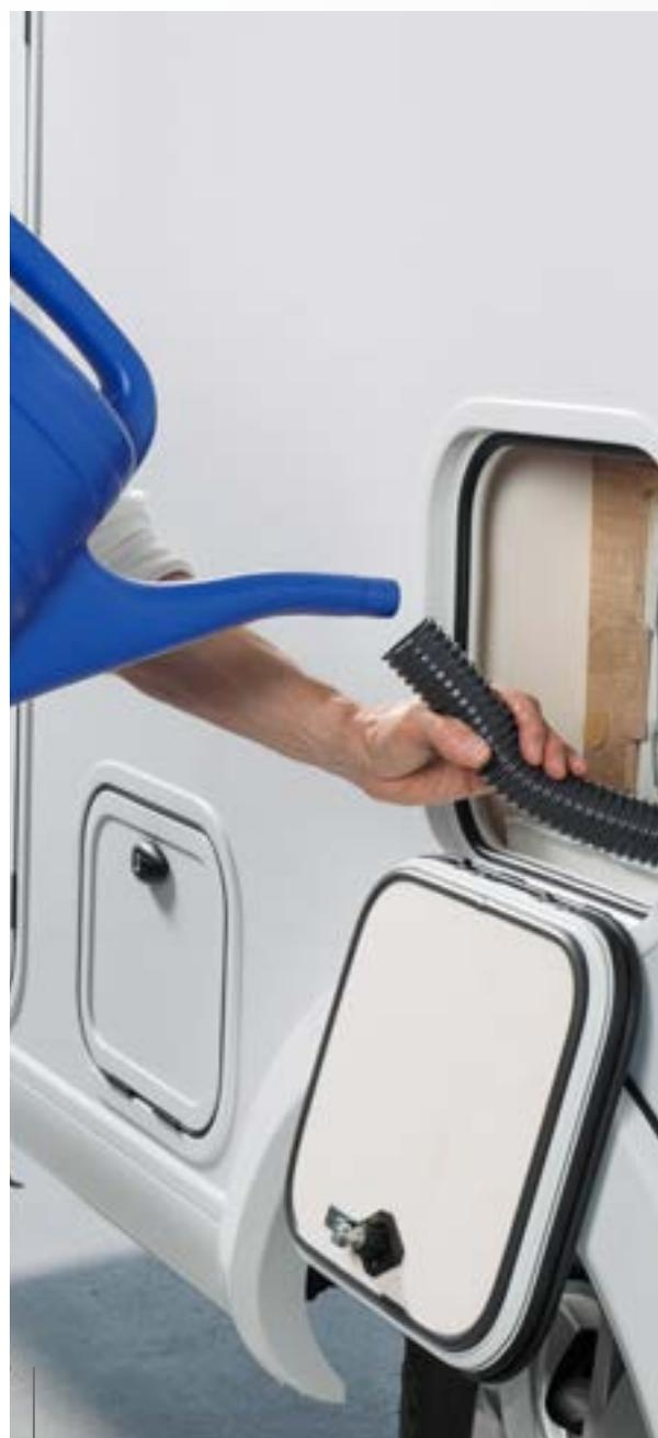
Pratique: si aucun robinet n'est disponible, le réservoir d'eau propre de 150 l. peut être rempli en utilisant un arosier.
