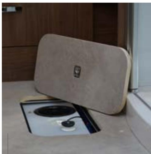
Trappe d'accès facile aux réservoirs d'eau et d'eaux usées.
