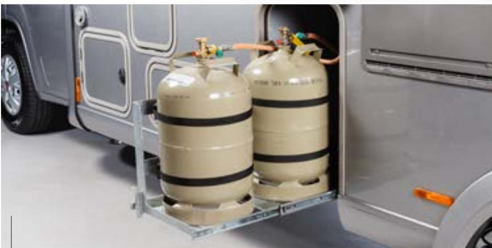
Les bouteilles de gaz sont faciles d'accès et placées à une hauteur idéale pour le dos. Chaque bouteille peut être échangée séparément.
