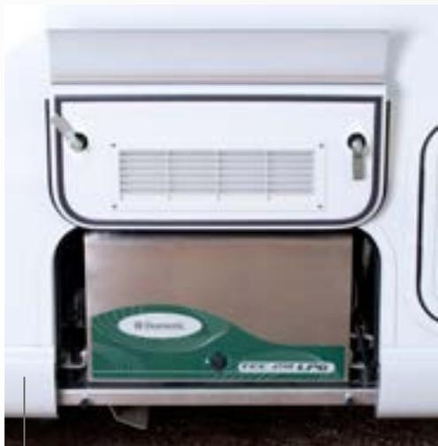
Le générateur Dometic Tec 29 crée du courant 220 V.
