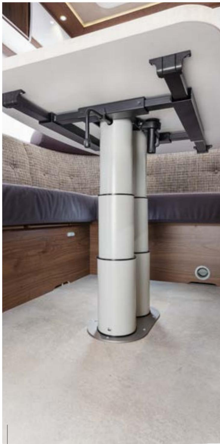
La table double-colonne, réglable en hauteur sans palier: ici le plateau mesure au minimum 85 cm de long, et coulisse naturellement dans les deux sens.
