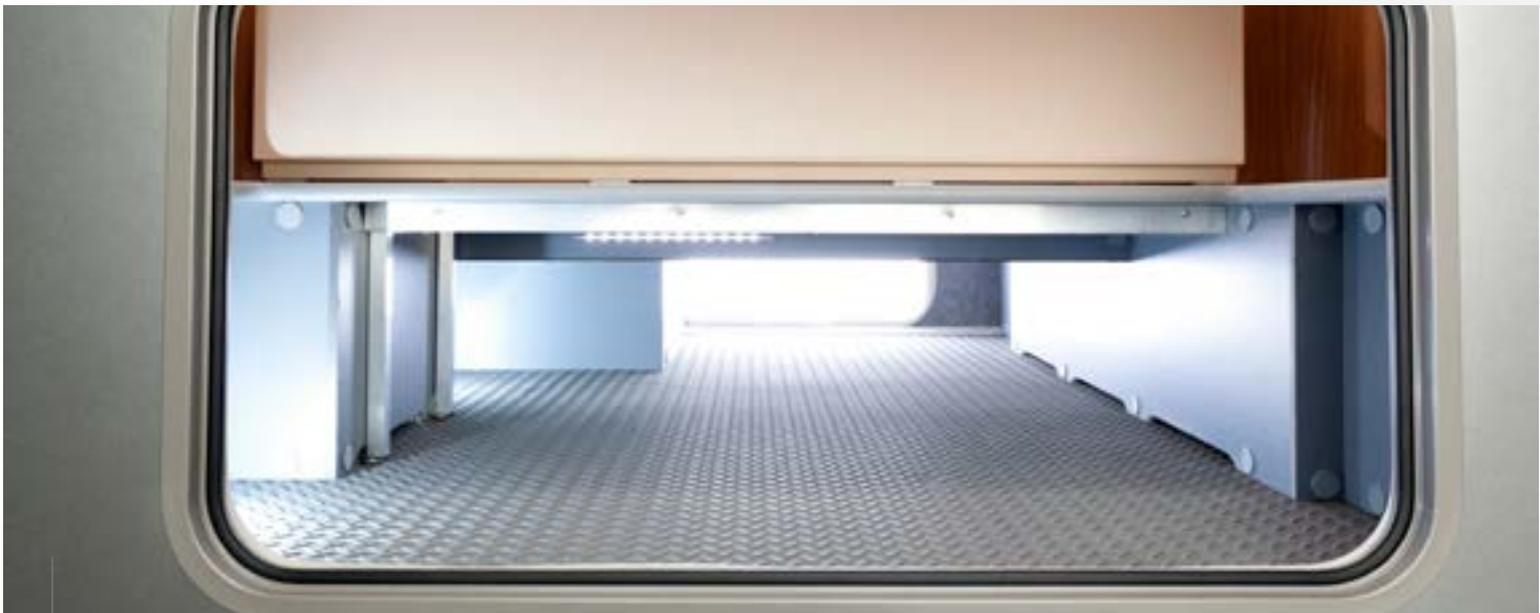
Conduites protégées du gel, plancher en polyester fibres de verre recouvert d'un revêtement qui stabilise les chargements, immense espace de stockage... ce sont là quelques-uns des nombreux avantages du double-plancher FRANKIA. Sur les modèles des séries F-Line et Selection, le double-plancher est traversant et permet le chargement d'objets longs.
