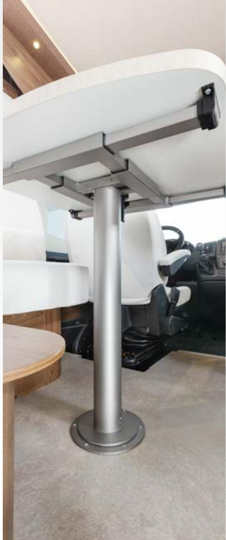
La table fixe est rotative autour d'un axe vertical, et pourvue d'un plateau coulissant.
