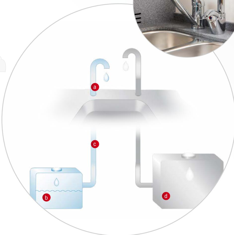
**a** **Acqua potabile igienica, pulita e pura** dal rubinetto di acqua dolce **b** **Il serbatoio di acqua dolce da 20 l** è integrato nel doppio fondo. Il prelievo facile e veloce tramite lo sportello esterno per il riempimento e la pulizia consente di avere regolarmente dell'acqua fresca **c** **Conduttura diretta dell'acqua** dal serbatoio di acqua dolce da 20 l **d** **Rubinetto dell'acqua standard** collegato a un serbatoio da 150 l per il normale uso domestico
