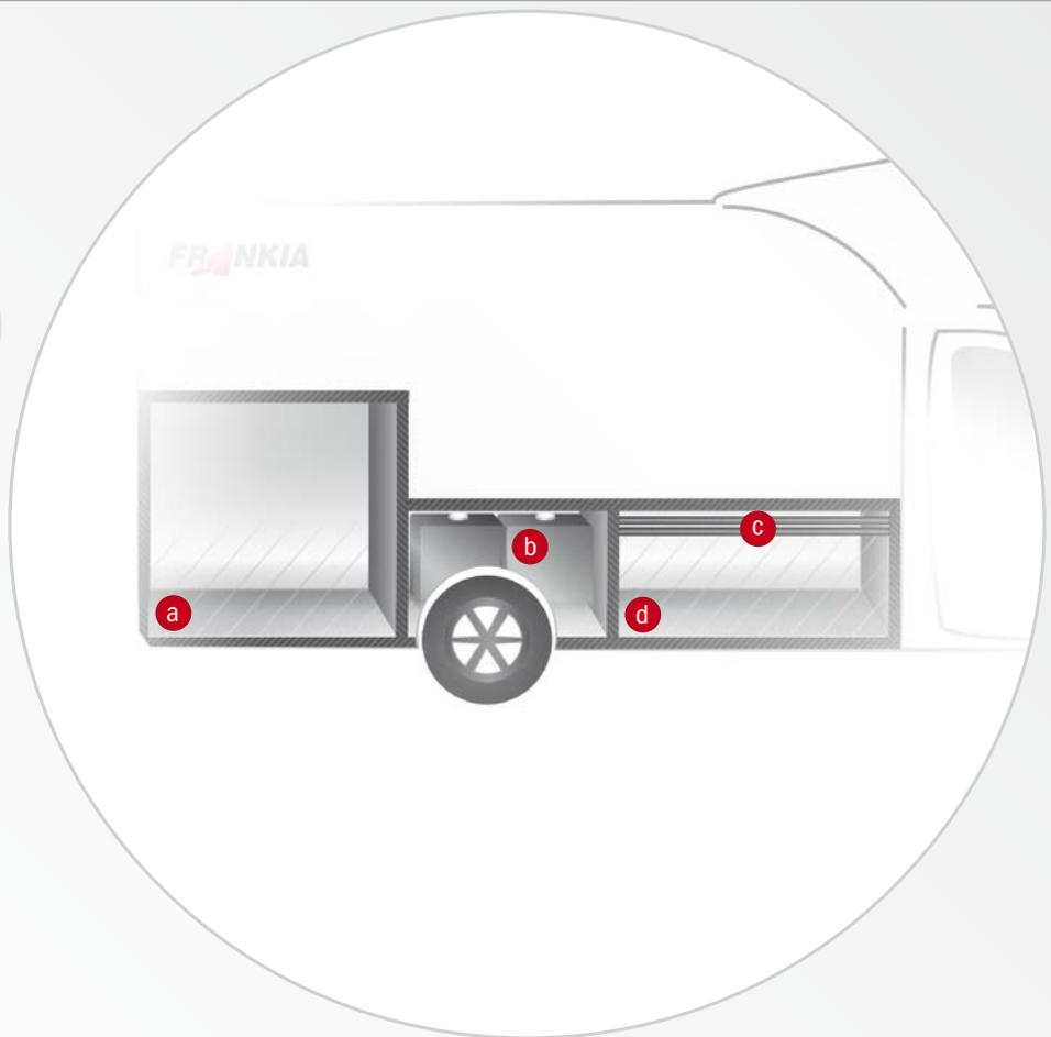
**a** Garage riscaldato **b** Serbatoio integrato per l'acqua dolce e per l'acqua di scarico per ancora più spazio nella zona giorno **c** Condotture protette contro il gelo grazie al doppio fondo riscaldato **d** Molto spazio utile nel doppio fondo continuo
