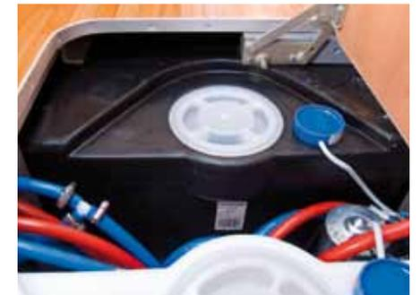
Réservoir eaux usées dans le double-plancher
