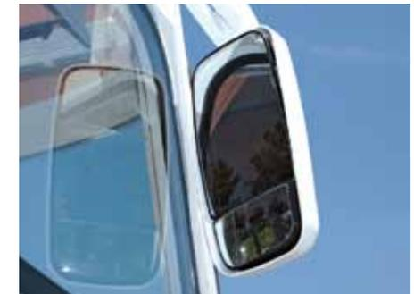
Rétroviseurs extérieurs chauffant et réglables électriquement (pour intégraux)
