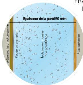
FRANKIA offre à ses clients pour toutes les longueurs une épaisseur de mur de 34 mm. Le plus FRANKIA: cette méthode coûteuse n'est pas seulement utilisée pour les parois mais aussi pour le toit et le plancher. Les portillons extérieurs ont également cette épaisseur. Sur les châssis IVECO nous montons des parois de 50 mm.
