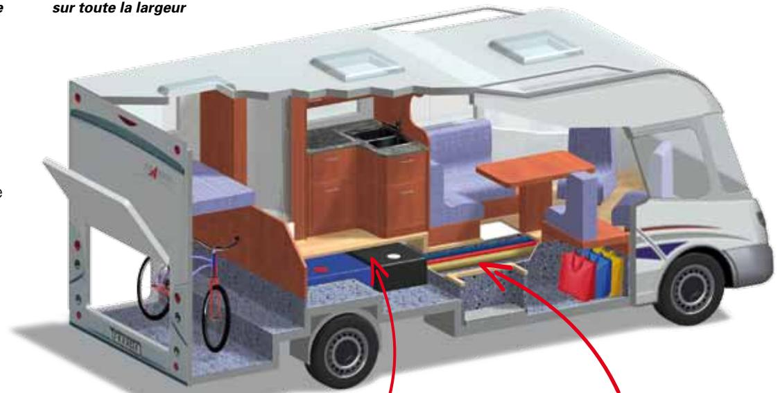
\*Le double-plancher FRANKIA est chauffé. Il garantit ainsi que tous les tuyaux sont protégés contre le gel en cas de températures extérieures allant jusqu'à -15 °C.
