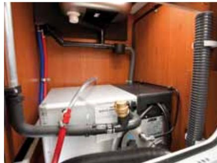
Chauffage Polar FRANKIA (avec Luxury) pour chauffage à eau avec chauffage auxiliaire
