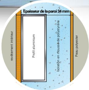
Le concept de construction FRANKIA mise sur l'écorce extérieure renforcée par fibres de verre (GFK) et son profil aluminium très résistant plutôt que sur une carcasse en bois. Muni d'une matière isolante polystyrène résistante à l'humidité, ce système permet d'avoir les meilleures conditions climatiques possibles. Afin d'atteindre une stabilité des parois encore plus grande et d'éviter les infiltrations de froid, l'isolation polystyrène est fraisée autour des tringles alu.
