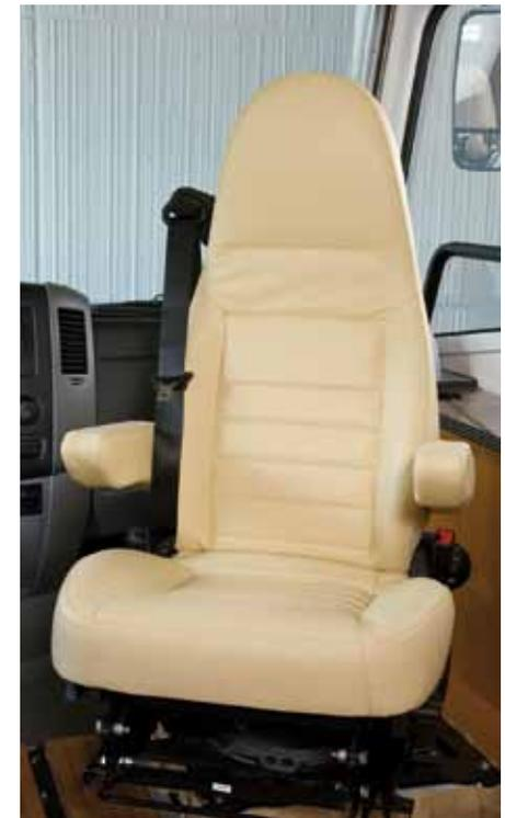
Siège-pilote pivotant, réglage de l'inclinaison et de la hauteur, coloris assorti aux banquettes (intégraux Mercedes)
