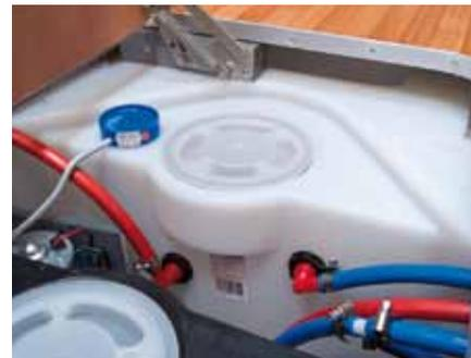
Réservoir à eau propre dans le double-plancher
