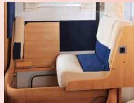
Banquette pivotante avec ceinture de sécurité (seulement côté chauffeur / selon implantation)
