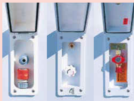
Prise de raccord au réseau local, douche extérieure, prise de gaz extérieure
