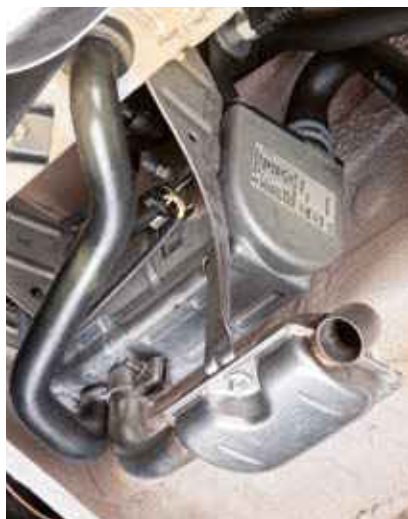
Le chauffage auxiliaire
