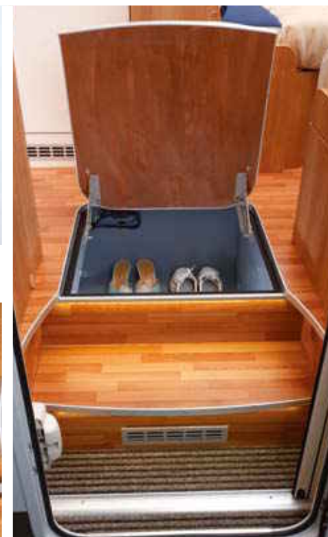
Éclairage entrée avec marche-pied électrique et coffre à chaussures
