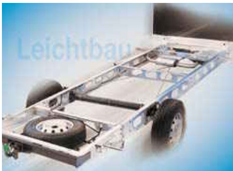
Châssis ALKO surbaissé pour châssis Fiat et Mercedes (6400/6800/7900 6 t / 8400 6 t)
