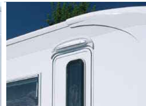
Éclairage extérieur au dessus de la porte cellule
