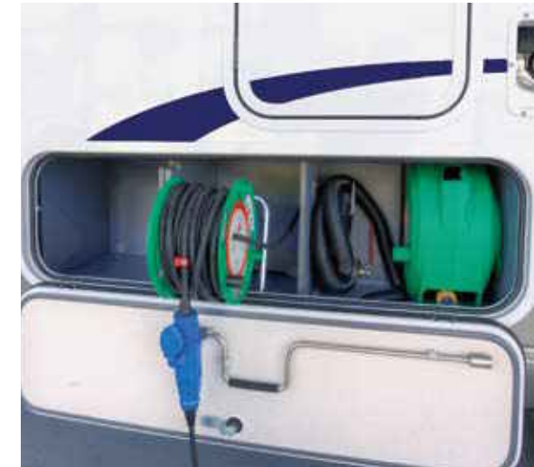
La nouvelle centrale d'alimentation avec tambour de câble rabattable (en option pour FF2 et FF4)
