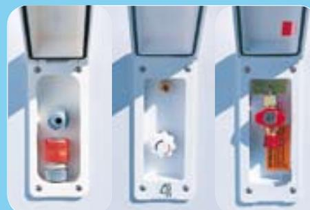
Prise de raccord au réseau local, douche extérieure, prise de gaz extérieure
