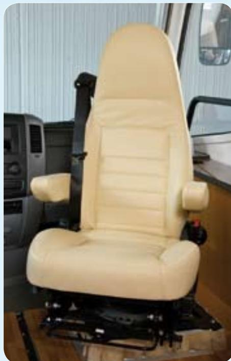
Siège tournant réglable en hauteur / inclinaison (intégraux sur Mercedes)
