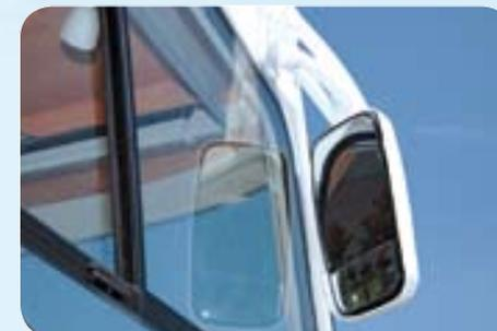
Rétroviseurs électriques et chauffants (intégraux)
