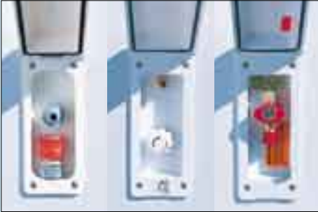
Presca acqua per collegamento alla rete idrica, doccia esterna calda fredda, presa gas esterna
