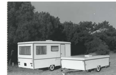
Création de la caravane pliante rigide. Elle est équipée d'un dépliage assisté à verrouillage automatique
