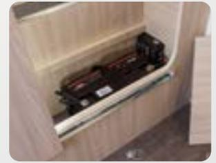
**Batterie lithium-ion** Puissante autonomie en option : la batterie lithium-ion 100 Ah dotée d'un booster de charge offre de larges réserves.
