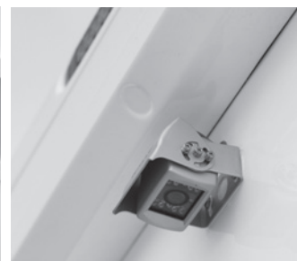
Caméra de recul : pour des manoeuvres plus faciles et précises, se met automatiquement en marche lors du passage en marche arrière.
