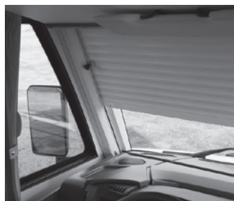
Volets roulants électriques : pour l'Integra Line et l'Integra Line LS, protection idéale contre les regards indiscrets et isolation supplémentaire de la cabine
