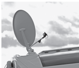
Antenne satellite : pour réception TV et radio en Europe, avec direction automatique
