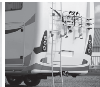
Echelle : installation fixe côté arrière du véhicule pour un accès facile au toit
