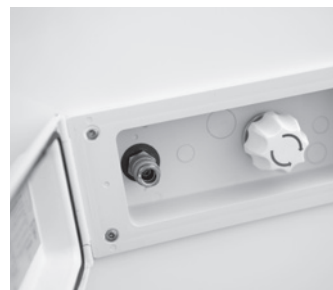
Douche extérieure : chaud/froid, installation côté conducteur
