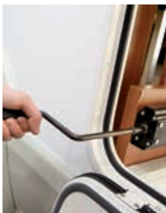
Réglage hydraulique de la hauteur dans le Terrestra A 690 HB (en option).
