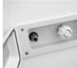
Douche extérieure : eau froide et chaude, installation côté conducteur
