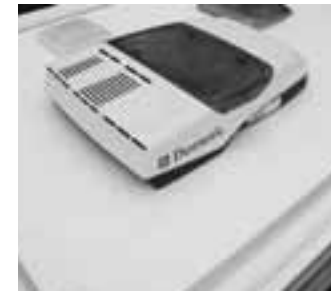
Climatisation Dometic; système puissant de 230 V, installation sur le toit
