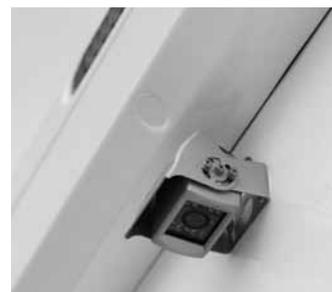
**Caméra** de recul pour des manœuvres simples, s'active automatiquement lors du passage en marche arrière et montre une perspective grand-angle de l'arrière du véhicule.
