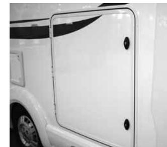
**Deuxième clapet** de garage pour avoir aussi une accessibilité optimale côté conducteur (selon implantation)
