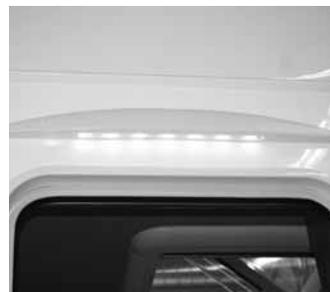
**Eclairage extérieur** : pour éclairer la partie porte, selon modèle avec écoulement d'eau intégré
