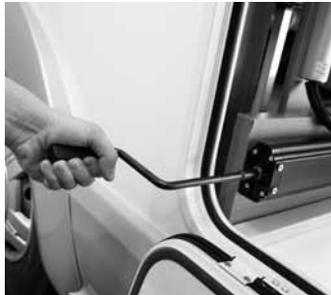
**Réglage hauteur lit arrière** en continu, hydraulique pour certains modèles avec garage (selon implantation), commande manuelle
