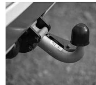
**Attelage de remorque**: capacité de charge de traction selon modèle
