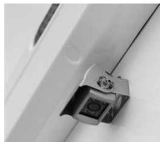
**Caméra** de recul pour des manœuvres simples, s'active automatiquement lors du passage en marche arrière et montre une perspective grand-angle de l'arrière du véhiculé e.
