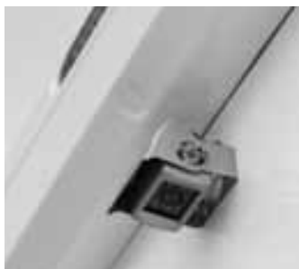
Caméra de recul pour des manœuvres simples, s'active automatiquement lors du passage en marche arrière et montre une perspective grand-angle de l'arrière du véhiculéte e.
