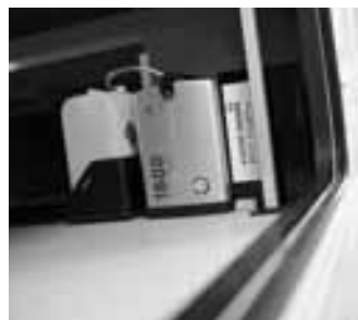
Cellule EFOY : chargement d'appoint des batteries cellule par une cellule électrochimique alimentée en méthanol.
