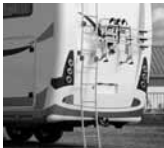
Échelle fixe à l'arrière du véhicule pour un accès facile au toit
