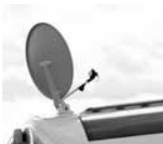
Antenne satellite : pour réception TV et radio en Europe, orientation automatique ou manuelle
